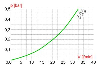
Unidad de intercambiador de calor (PWT + sistema de conexión especial) N.º de pos.: "4"
